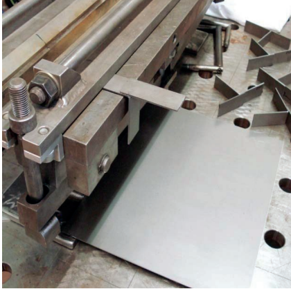
Рис. 17. Зажимний пристрій і зварювання Т – зразка (406)
