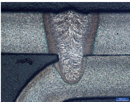
Рис. 19. Поперечні перерізи зварних швів зразків Т – форми 401 і 405 відповідно
