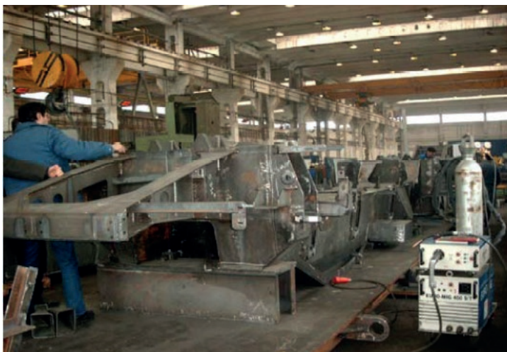
Рис. 6. Автомобільна рама із сталі S960QL для 80 т крана 25
