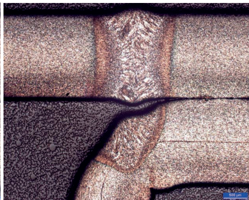
Рис. 22. Мікро шліф не повністю проварених зразків 406 і 506 відповідно
