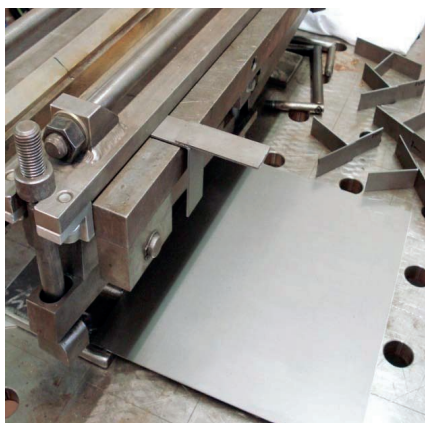
Рис. 17. Зажимний пристрій і зварювання Т – зразка (406)
