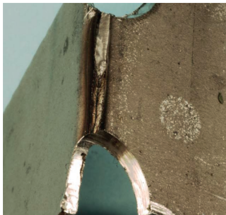
Рис. 21. Зруйнований шов: а – не суцільний шов з тріщинами; б – зміна забарвлення шва під дією тепла
