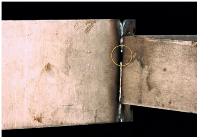
Рис. 20. Розірваний зварний шов заготовки А – форми (406)
