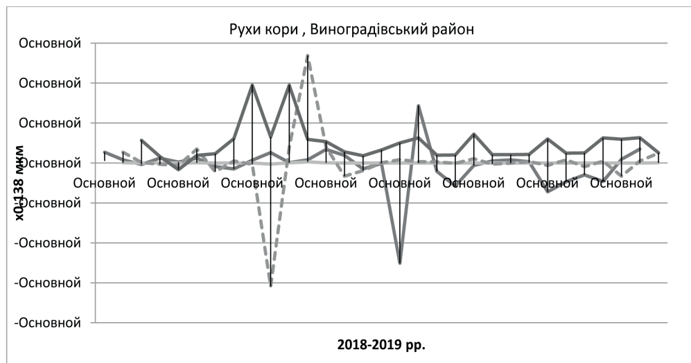
Рис.26. Рухи кори (горизонтальні, напрямок схід–захід) за геодезичними спостереженнями – штрих лінія; за деформометричними спостереженнями – крива сірого кольору; рухи кори в напрямку північ–південь (крива чорного кольору). 2018-2019 рік. Виноградівський район.
