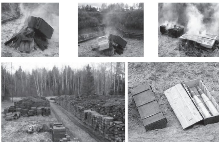
Рис. 15.7. Загоряння дерев'яної тари для зберігання боєприпасів
