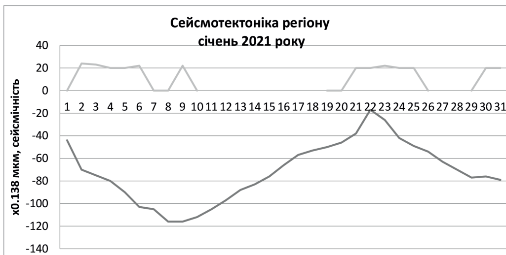
Рис. 2. Сейсмічні процеси (крива сірого кольору), сучасні рухи кори в зоні Оашського глибинного розлому (крива чорного кольору). Січень 2021 року. Закарпатський внутрішній прогин.
